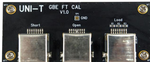
图 1-2 回波损耗测试校准夹具
