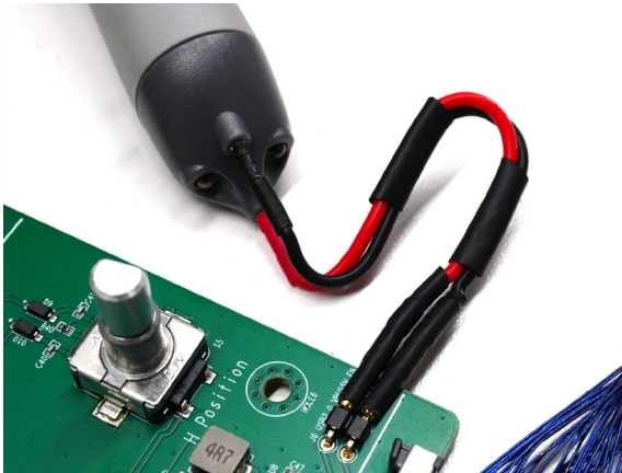
与 MSO7000X 示波器连接和柔性前端连接器，用于连接小型 DUT
